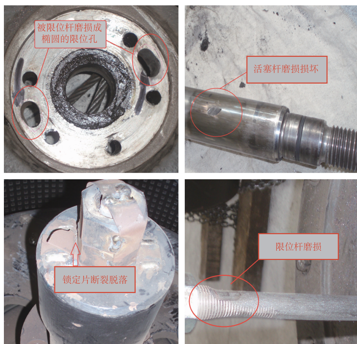
图 2-10 补气阀在运行过程中出现的损坏
