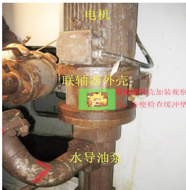
图 2-15 增设联轴器观察孔示意图
