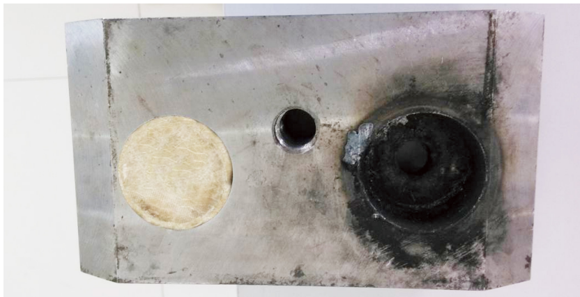
图3-2 固定块背部孔内加装绝缘堵板后的效果图
