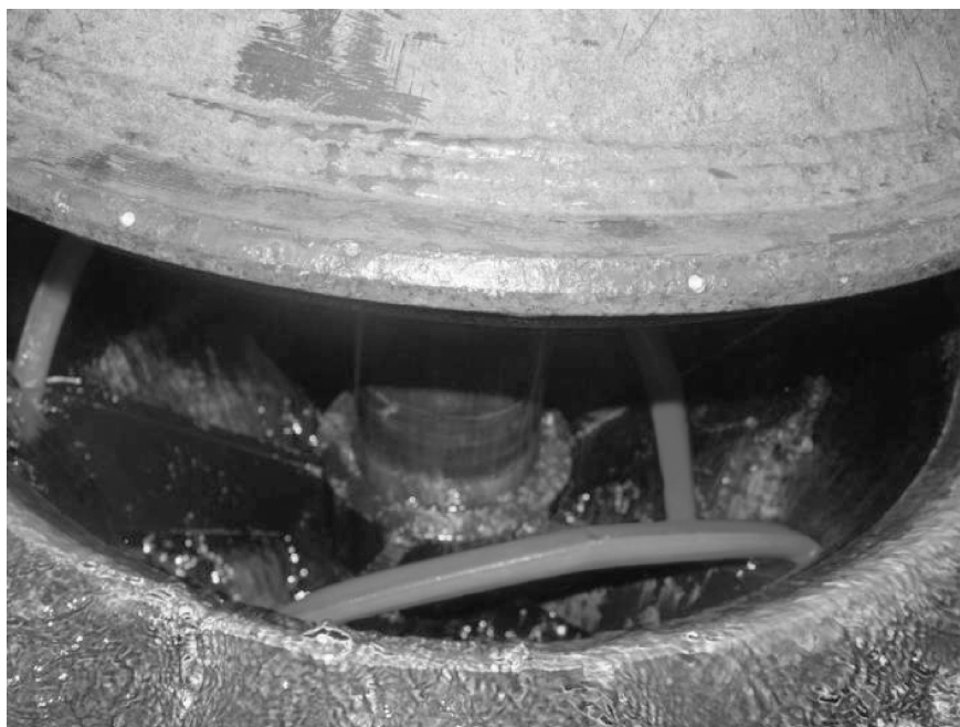
图 2-5 橡胶材质的盘型阀密封脱落情况
